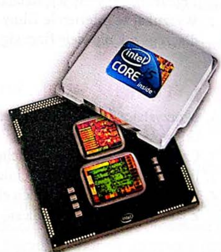
Rys. 25.6. Fizyczna budowa procesora
