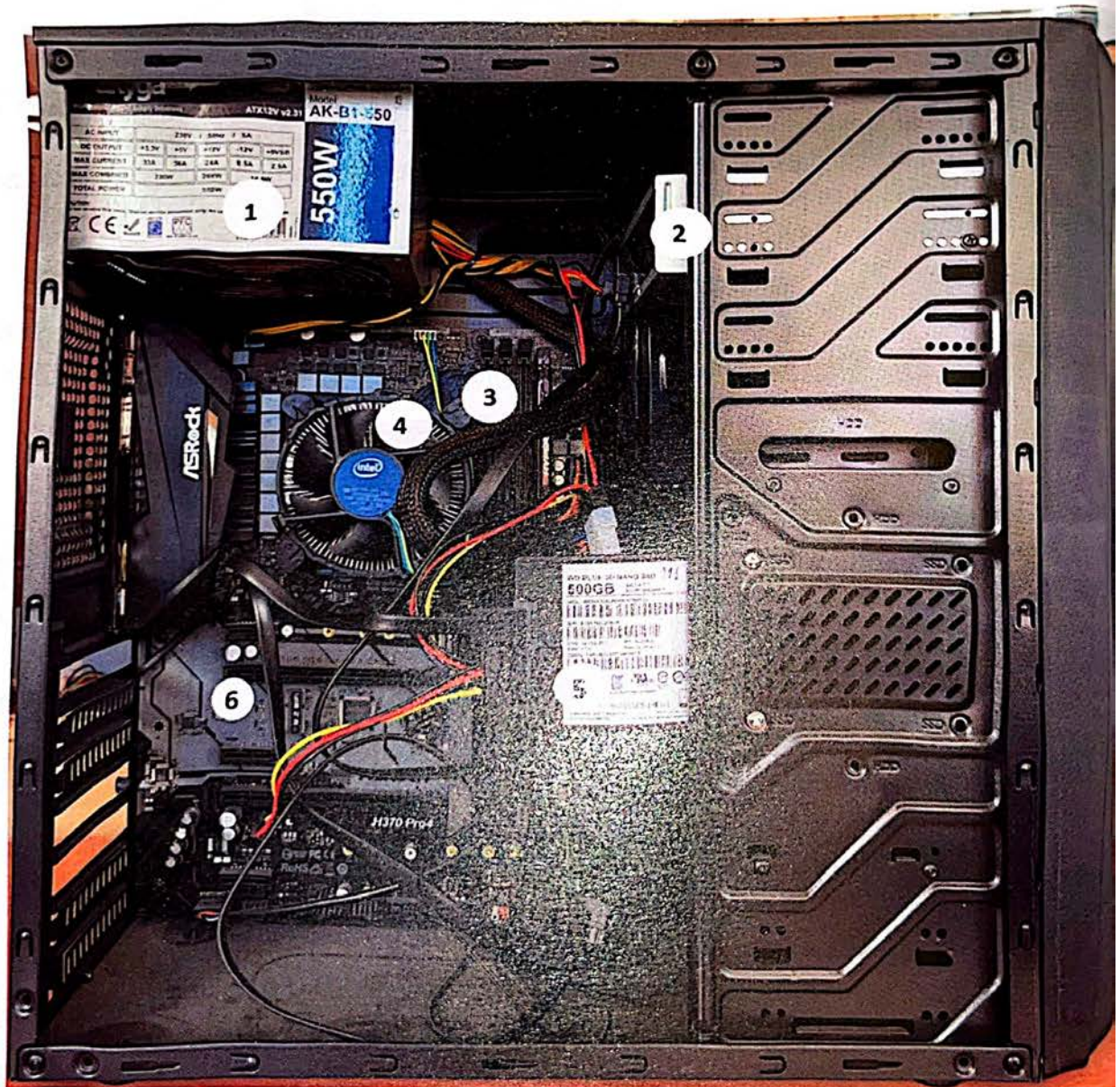
Rys. 24.2. Rozmieszczenie podstawowych elementów jednostki centralnej 1 – zasilacz, 2 – napęd optyczny, 3 – pamięć RAM, 4 – procesor, 5 – dysk SSD, 6 – płyta główna
