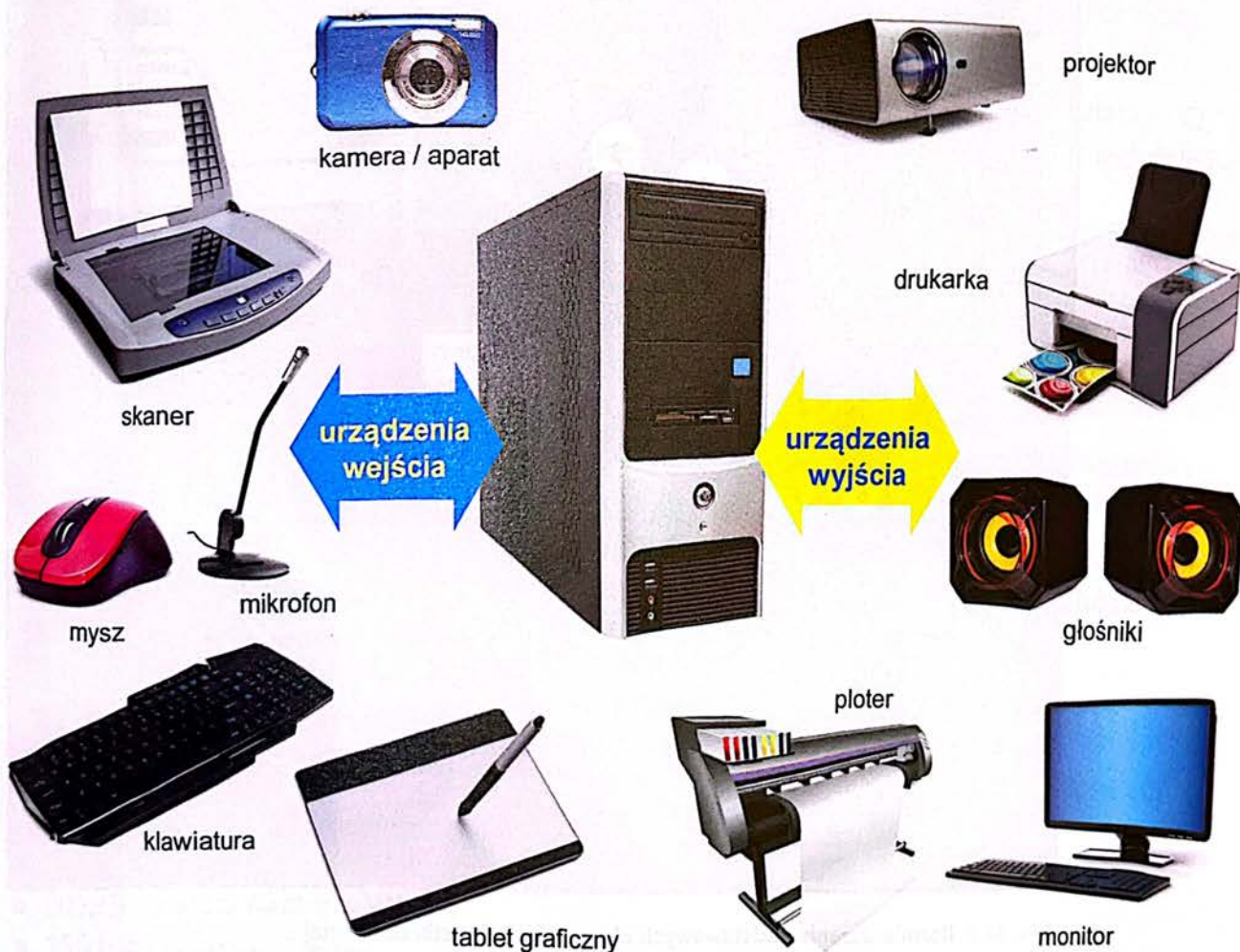
Rys. 24.1. Elementy wejścia i wyjścia
