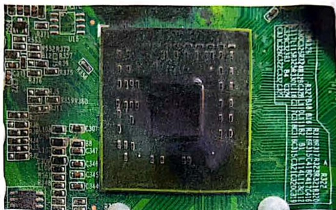
Rys. 27.7. Przykład spalenia układu BGA
